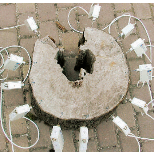
Linden-Stammsscheibe mit Höhlung und zwölf angebrachten Sensoren.
