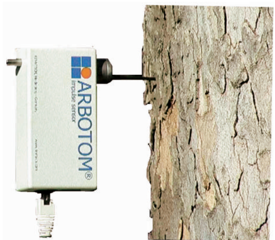
Erschütterungssensor im schlag- und spritzwasserfesten Gehäuse mit Schlagstift (links oben), Nagel-Halterung (rechts oben) und Steck-Kabel-Anschluss.
